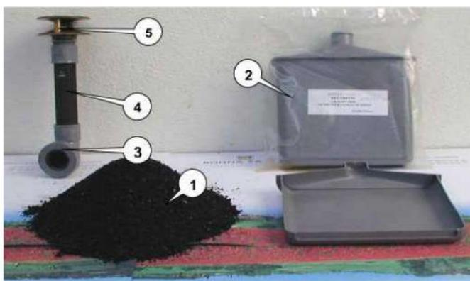
La ventilation naturelle par décompression des gaz est assurée par la différence de pression entre l'intérieur et l'extérieur du caveau. Les gaz s'échappent naturellement par la base du filtre en traversant les charbons actifs qui piègent les composés malodorants, ainsi toute émission nauséabonde est évitée.
